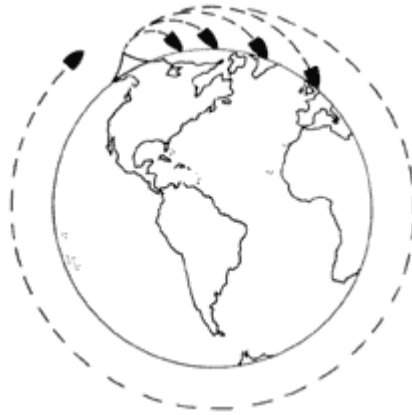
Figura 26. Un satélite en órbita es un caso extremo de proyectil de caída libre.
